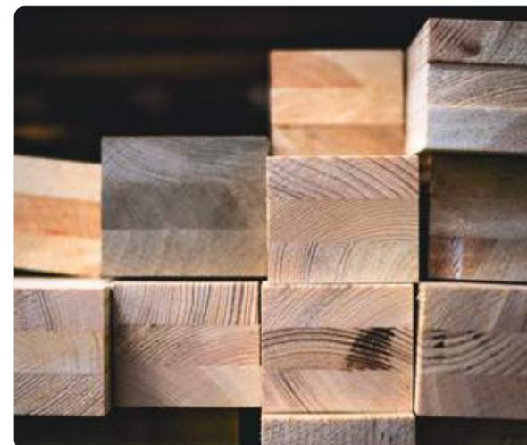
Utilisation de carrelés en lamellé-collé 3 plis pour une meilleure stabilité
