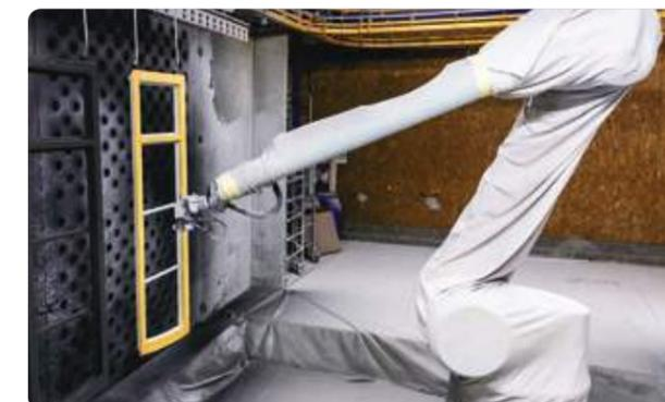
La couche de finition est appliquée par le robot pour un résultat sans coulures. Ici réalisation d'une bicoloration.
