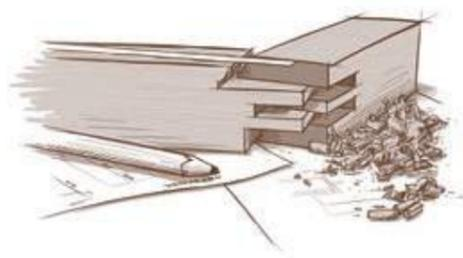
Nous utilisons un assemblage traditionnel - la technique du **double enfourchement pour l'assemblage des ouvrants** (tenon et mortaise).
