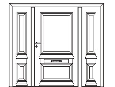
Odysée avec semi-fixe (ouvrable) et fixe en faux ouvrant coordonné. H 2150 / L 2190.
