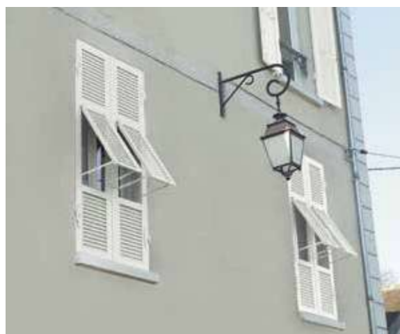
Volets battants modèle JS avec projection à l'italienne
