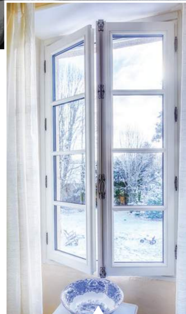
Fenêtre Estilou Finition peinture blanche RAL 9016 Parceloses et petits bois horizontaux à doucine Crémone véritable et fiches turlupet vieil argent
