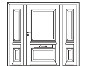
Odyssée avec semi-fixe (ouvrable) et fixe en faux ouvrant coordonné. H 2150 / L 2190.
